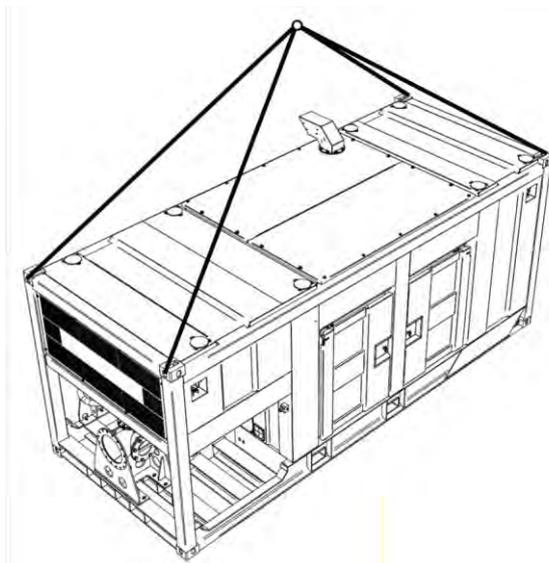
Pour les boîtiers de type EL24-60 (taille de conteneur d'expédition), utilisez des twist-locks pour les opérations de levage.
