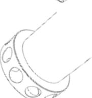
Плоский всасывающий сетчатый фильтр подходит для прокачки до самой низкой поверхности. (Не подходит для больших объемов и мягкого грунта).
