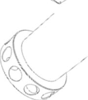
Der Flachsauger eignet sich zum Pumpen bis zum tiefstmöglichen Punkt. (Nicht geeignet für große Mengen und weichen Boden.)
