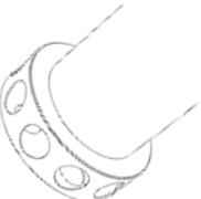
Płaski kosz ssawny jest odpowiedni do pompowania do najniższej możliwej powierzchni. (Nie nadaje się w przypadku pomp o dużej wydajności i miękkiego podłoża).
