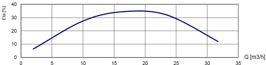
B30-180 pompa z silnikiem wysokoprężnym
