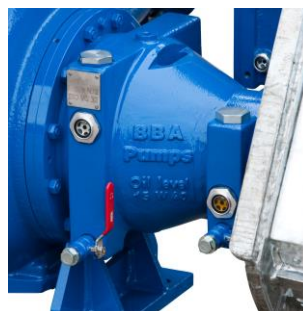
Łatwy dostęp do kontrolek Wszystkie wlewy oraz kontrolki poziomu płynów są łatwo dostępne
