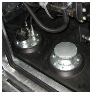
Zbiornik paliwa Odporny na korozję polyetylen (HDPE) umieszczony w podstawie zabudowy.
