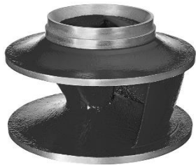
Lauftrad GGG40, Sphäroguss, Freier Durchgang 82 mm.
