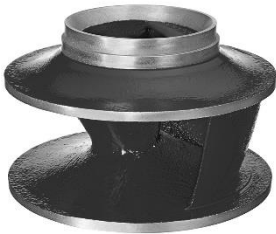
Kanaalwaaier GGG40 nodulair gietijzer, vuildoorlaat 82 mm.
