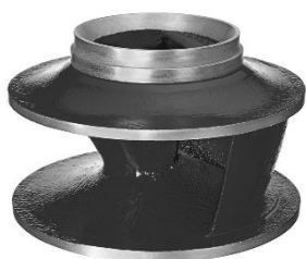
Канальное рабочее колесо Чугун GGG40, канальный тип, свободный проход 82 мм.
