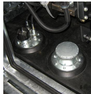
Brandstoftank Corrosievrije, 300 liter, kunststof brandstoftank, in lekdicthe onderbak.
